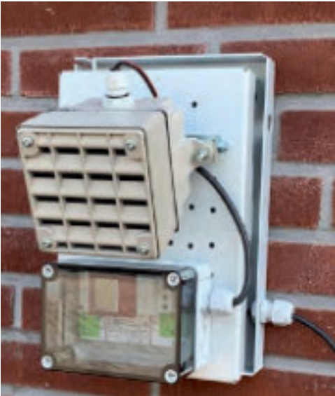
Mosquito(standaard) beschermkast met losse montageplaat met een IP-kastje met 230/24V kabelvoeding en Grässlin tijdschakelaar.
